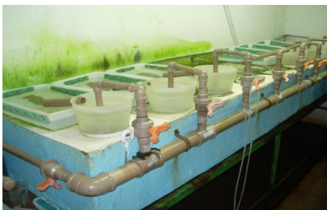
Figura 2 - Incubadoras e bandejas para ovos de tilápia.
